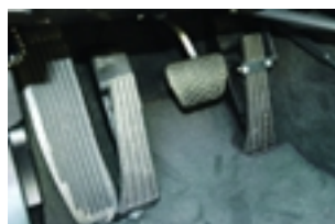
Intelligent: Mit der elektronischen Gaspedalverlegung kann das aktive Pedal auf Knopfdruck gewechselt werden
